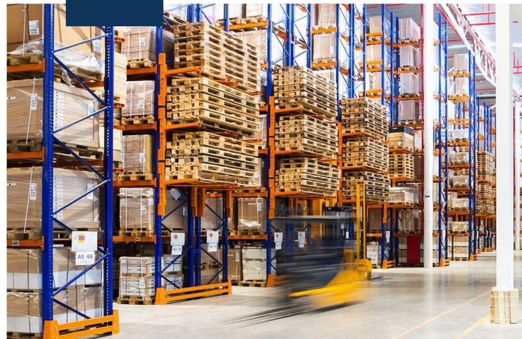
Le **scaffalature porta pallet** sono sistemi di stoccaggio progettati per immagazzinare unità di carico pallettizzate, composti da un numero minimo di elementi strutturali con un'ampia possibilità di personalizzazione, largamente utilizzate nei luoghi di lavoro per la facilità di montaggio e la eventuale riconfigurazione e ricollocazione.
